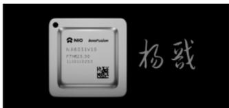
“楊戩”是行業首款自研激光雷達主控芯片，每秒處理點雲能力高達 800 萬點，激光雷達處理芯片功耗減少 50%，支持更複雜、更惡劣的行車場景。
